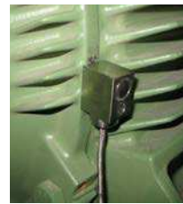
Gama de sensores SKF monitoreando puntos definidos y sistema de vigilancia en línea SKF IMx
