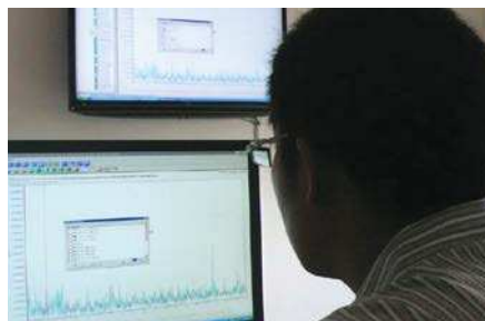
El análisis espectral con el software SKF @ptitude puede identificar las diferentes fuentes de vibración.
