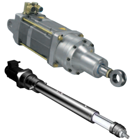
Los cilindros electromecánicos SKF pueden admitir cargas nominales de hasta 250 kN; velocidades lineales máximas de hasta 150 mm/s; y recorridos máximos de 700 mm. Se puede personalizar a pedido.
