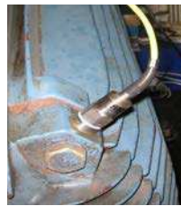
Gama de sensores SKF monitoreando puntos definidos y sistema de vigilancia en línea SKF IMx
