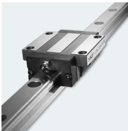
SKF ofrece las guías con patines LLT en seis tamaños (15, 20, 25, 30, 35 y 45 mm) y 6 carros.
