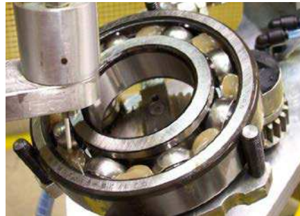
SKF puede proporcionar llenados de grasa personalizados (de 10 a 100%)
